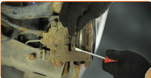
**11** Rimuovere i tappi dei parapolvere delle guide pinza freno. Usa un giravite piatto.
