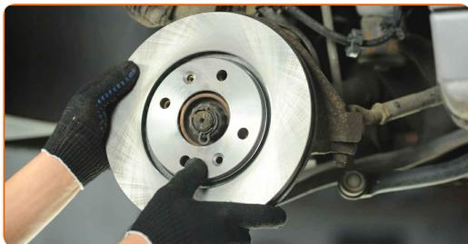
**24** Serrare gli elementi di fissaggio del disco del freno. Usa un cacciavite Phillips. Usa la chiave Torx T30. Usa una chiave dinamometrica. Serralo fino allo coppia di torsione di 10 Nm.
