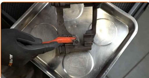
**30** Pulisci gli elementi di fissaggio del supporto pinza freno. Usa una spazzola metallica. Usa lo spray WD-40.
