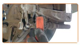
Svitare l'attacco della pinza freno. Utilizza una chiave combinata N°19. Utilizza una chiave a bussola N°13. Usa una chiave a cricchetto.
