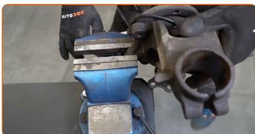
**37** Pulire la sede di montaggio del sensore ABS. Usa una spazzola metallica. Usa lo spray WD-40.
