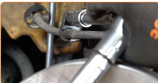
**83** Pulisci le sedi di montaggio del tirante della barra stabilizzatrice. Usa una spazzola metallica. Usa lo spray WD-40.
