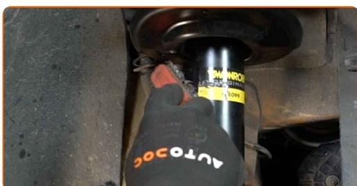
10 Svita gli elementi di fissaggio che collegano il tirante della barra stabilizzatrice al puntone dell'ammortizzatore. Utilizza una chiave a bussola N°17. Usa una chiave a cricchetto.
