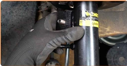
**85** Serra gli elementi di fissaggio che collegano il tirante della barra stabilizzatrice al puntone dell'ammortizzatore. Utilizza una chiave a bussola N°17. Usa una chiave dinamometrica. Serralo fino allo coppia di torsione di 43 Nm.
