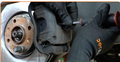
**16** Pulisci gli elementi di fissaggio del supporto pinza freno. Usa una spazzola metallica. Usa lo spray WD-40.
