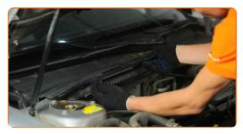
Rimuovere dall'alloggiamento del filtro l'elemento filtrante da sostituire. Usa un giravite piatto.
