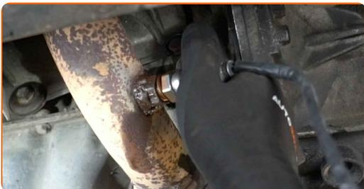
**11** Stringere l'elemento di fissaggio del sensore di ossigeno. Utilizza una chiave combinata N°22. Usa una chiave dinamometrica. Serralo fino allo coppia di torsione di 47 Nm.
