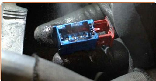
**13** Collegare il connettore del sensore di ossigeno.
