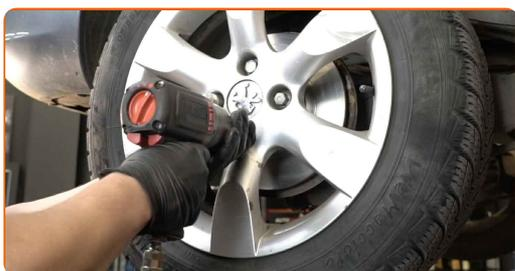
**33** Rimettere il veicolo per terra e, lavorando in ordine incrociato, serrare i bulloni di fissaggio delle ruote. Usa la chiave a bussola per dadi cerchio ruota n.17. Usa una chiave dinamometrica. Serralo fino allo coppia di torsione di 100 Nm.
