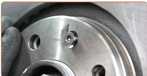
**25** Serrare gli elementi di fissaggio del disco del freno. Usa la chiave Torx T 30. Usa una chiave dinamometrica. Serralo fino allo coppia di torsione di 10 Nm.
