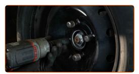
Rimettere il veicolo per terra e, lavorando in ordine incrociato, serrare i bulloni di fissaggio delle ruote. Usa la chiave a bussola per dadi cerchio ruota n.19. Usa una chiave dinamometrica. Serralo fino allo coppia di torsione di 90 Nm.
