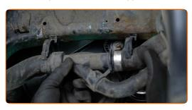
Pulire l'elemento di fissaggio della puleggia del tenditore. Usa una spazzola metallica.
