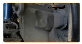
Installa e serra gli elementi di fissaggio del parasassi del passaruota. Usa uno strumento per estrazione clip. Usa un cacciavite Phillips.
