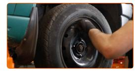
Svita e rimuovi gli elementi di fissaggio del parasassi del passaruota. Usa uno strumento per estrazione clip. Usa un cacciavite Phillips.
