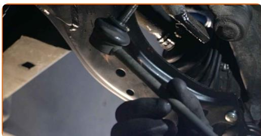
Sostituzione: biellette barra stabilizzatrice - PEUGEOT 306 Van / Hatchback. I professionisti raccomandano:
