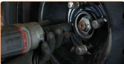
**21** Rimettere il veicolo per terra e, lavorando in ordine incrociato, serrare i bulloni di fissaggio delle ruote. Usa la chiave a bussola per dadi cerchio ruota n.19. Usa una chiave dinamometrica. Serralo fino allo coppia di torsione di 90 Nm.
