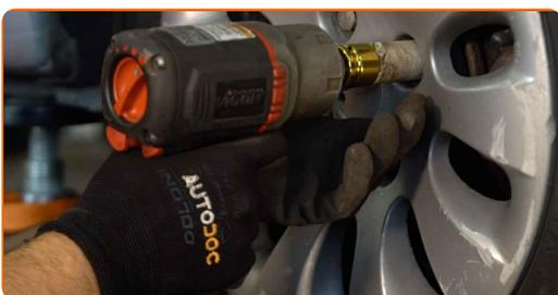
**32** Rimettere il veicolo per terra e, lavorando in ordine incrociato, serrare i bulloni di fissaggio delle ruote. Usa una chiave dinamometrica. Serralo fino allo coppia di torsione di 100 Nm.
