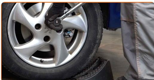
**75** Stringi l'elemento di fissaggio superiore del supporto di ammortizzazione. Utilizza una chiave a bussola N°13. Usa una chiave dinamometrica. Serralo fino allo coppia di torsione di 25 Nm.
