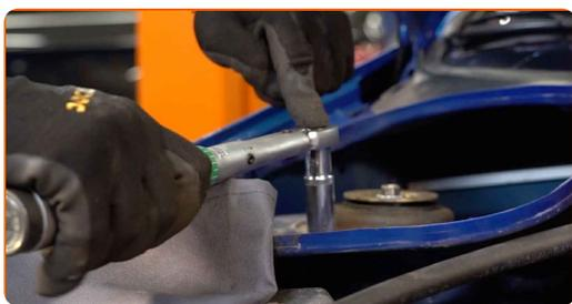
**76** Tratta con del prodotto gli elementi di fissaggio del supporto del puntone dell'ammortizzatore. Usa il grasso al rame.
