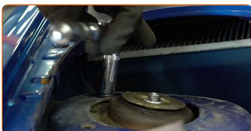
**51** Tratta la sede di montaggio del puntone dell'ammortizzatore sul fuso a snodo. Usa una spazzola metallica. Usa lo spray WD-40.
