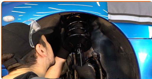
**50** Avvita l'elemento di fissaggio superiore del montante supporto ammortizzazione. Utilizza una chiave a bussola N°13. Usa una chiave a cricchetto. Non lo serrare.
