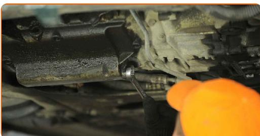
**17** Pulisci la zona del foro di drenaggio della coppa dell'olio. Usa un detergente spray multiuso.
