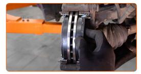
Montare la pinza del freno e fissarla. Utilizza una chiave combinata N°13. Utilizza una chiave a bussola N°13. Usa una chiave dinamometrica. Serralo fino allo coppia di torsione di 30 Nm.
