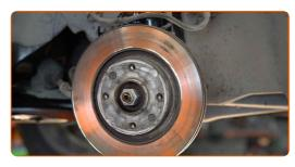
Pulisci gli elementi di fissaggio del disco freno. Usa una spazzola metallica. Usa lo spray WD-40.
