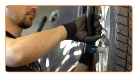
Rimettere il veicolo per terra e, lavorando in ordine incrociato, serrare i bulloni di fissaggio delle ruote. Usa una chiave dinamometrica. Serralo fino allo coppia di torsione di 100 Nm.
