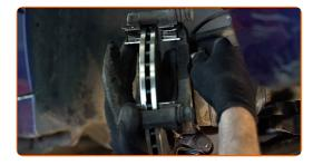
Serrare il sostegno pinza freno. Usa la chiave Torx T55. Usa una chiave dinamometrica. Serralo fino allo coppia di torsione di 105 Nm.
