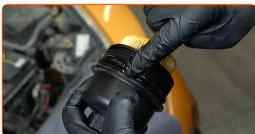
**19** Installare una nuova calotta carter filtro olio e serrarla. Utilizza una chiave a bussola N°27. Usa una chiave dinamometrica. Serralo fino allo coppia di torsione di 25 Nm.
