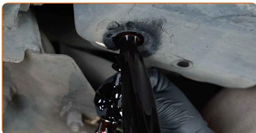
Sostituzione: olio motore e filtro - PEUGEOT 3008 (T8). Consiglio:
