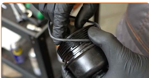
**17** Installa il nuovo filtro dell'olio alla sede di montaggio del coperchio del filtro.
