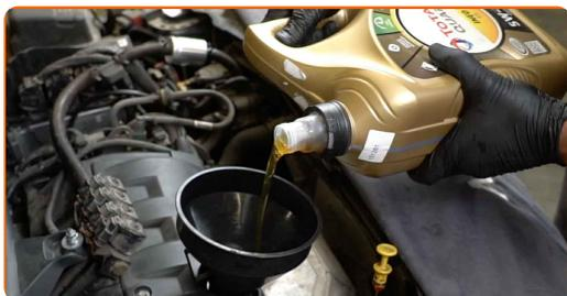
Sostituzione: olio motore e filtro - PEUGEOT 3008 (T8). Il consiglio di AUTODOC:
