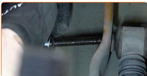
**12** Pulisci gli elementi di fissaggio dell'ammortizzatore. Usa una spazzola metallica. Usa lo spray WD-40.
