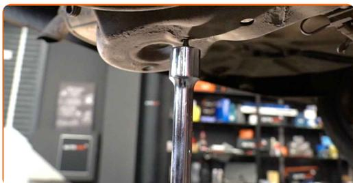
**9** Pulisci gli elementi di fissaggio dell'ammortizzatore. Usa una spazzola metallica. Usa lo spray WD-40.
