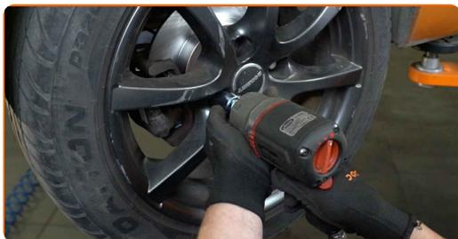
**34** Rimettere il veicolo per terra e, lavorando in ordine incrociato, serrare i bulloni di fissaggio delle ruote. Usa la chiave a bussola per dadi cerchio ruota n.17. Usa una chiave dinamometrica. Serralo fino allo coppia di torsione di 100 Nm.
