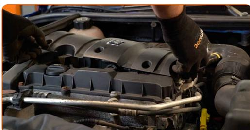
Sostituzione: candele di accensione - PEUGEOT 208 II Hatchback (UB\_, UP\_, UW\_, UJ\_). AUTODOC raccomanda:
