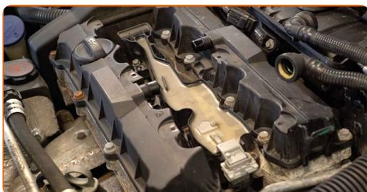
**19** Serra gli elementi di fissaggio delle bobine di accensione. Usa la chiave Torx T 20. Usa una chiave dinamometrica. Serralo fino allo coppia di torsione di 8 Nm.
