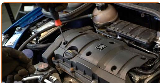
**4** Rimuovere la copertura del motore.
