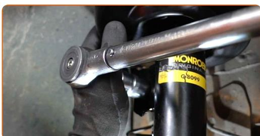
**13** Serra gli elementi di fissaggio che collegano il tirante della barra stabilizzatrice alla barra. Utilizza una chiave a bussola N°17. Usa una chiave dinamometrica. Serralo fino allo coppia di torsione di 43 Nm.
