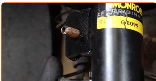
**12** Serra gli elementi di fissaggio che collegano il tirante della barra stabilizzatrice al puntone dell'ammortizzatore. Utilizza una chiave a bussola N°17. Usa una chiave dinamometrica. Serralo fino allo coppia di torsione di 43 Nm.
