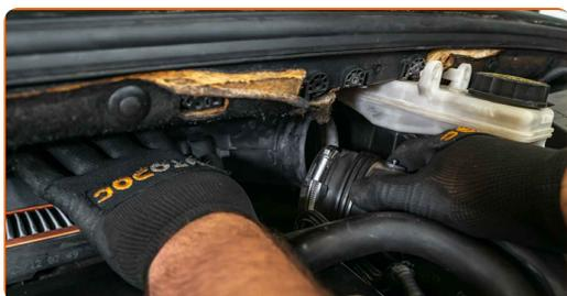
**15** Stringi il morsetto e gli elementi di fissaggio sul tubo di aspirazione del filtro dell'aria. Utilizza una chiave combinata N°7.
