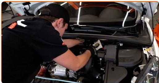
**13** Avvita le viti di serraggio sul coperchio del filtro dell'aria (3 pezzi). Usa la chiave Torx T25. Usa una chiave a cricchetto.
