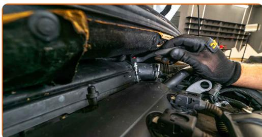
**14** Collega il tubo di aspirazione dell'aria all'alloggiamento del filtro dell'aria.
