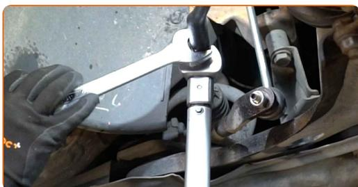
**19** Tratta con del prodotto l'elemento di fissaggio che collega la testina tirante al fuso a snodo. Usa il grasso al rame.
