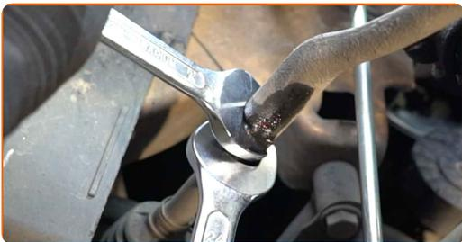
**9** Svitare il dado di attacco del gambo al fuso a snodo. Utilizza una chiave a bussola N°16. Usa un giramaschi.
