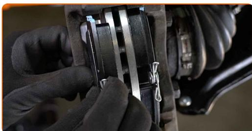
**18** Montare la pinza del freno e fissarla.
