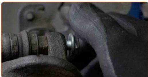
**20** Serra gli elementi di fissaggio della pinza del freno. Utilizza una chiave combinata N°13. Utilizza una chiave combinata N°15. Usa una chiave dinamometrica. Serralo fino allo coppia di torsione di 27 Nm.
