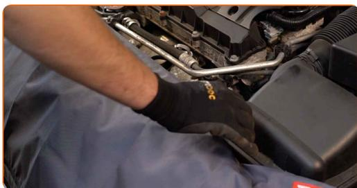
**3** Svita gli elementi di fissaggio del coperchio del motore. Usa la chiave Torx T 20.
