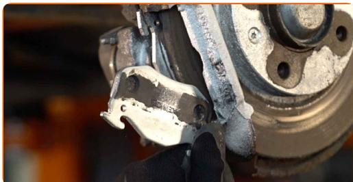
**11** Pulisci gli elementi di fissaggio della pinza freno. Usa una spazzola metallica. Usa lo spray WD-40.
