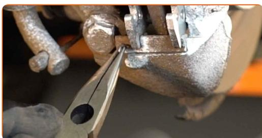
**8** Pulisci gli elementi di fissaggio della pinza freno. Usa una spazzola metallica. Usa lo spray WD-40.
