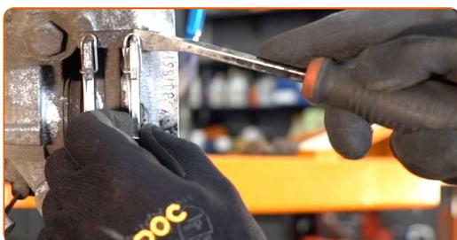
**7** Rimuovi il perno di fissaggio della pastiglia freno. Usa delle pinze a becchi lunghi.
