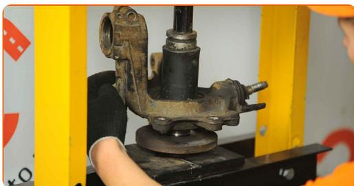
**47** Tratta la sede di montaggio del puntone dell'ammortizzatore sul fuso a snodo. Usa una spazzola metallica. Usa lo spray WD-40.
