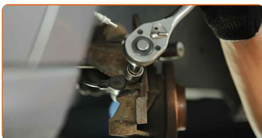
**31** Rimuovere il sensore ABS dal fuso a snodo dello sterzo.
