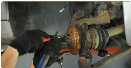
**26** Pulisci l'elemento di fissaggio del mozzo della ruota. Usa una spazzola metallica. Usa lo spray WD-40.
