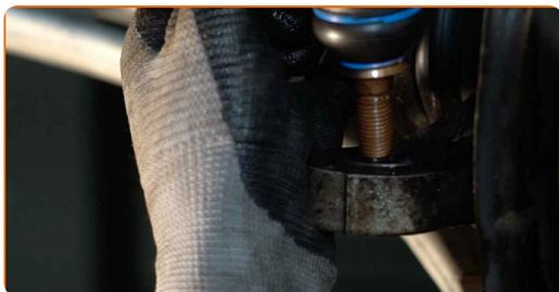
**63** Serra il bullone di fissaggio che collega la testina tirante al fuso a snodo. Utilizza una chiave a bussola N°17. Usa una chiave dinamometrica. Serralo fino alla coppia di torsione di 35 Nm.
