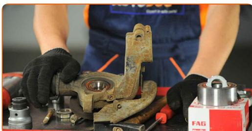
**37** Estrarre il mozzo della ruota dal fuso a snodo. Usare un set di montaggio/smontaggio cuscinetti e boccole. Usa un martello.
