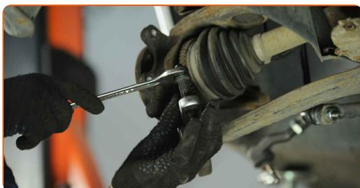
**25** Rimuovere la coppia di fissaggio del dado del mozzo. Usa delle pinze a becchi lunghi. Usa un giravite piatto.
