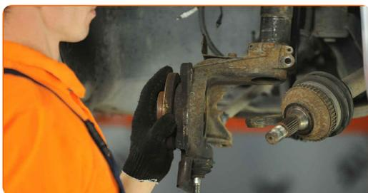
**30** Svitare l'elemento di fissaggio che collega il sensore ABS al fuso a snodo dello sterzo. Utilizza una chiave a bussola N°10. Usa una chiave a cricchetto.
