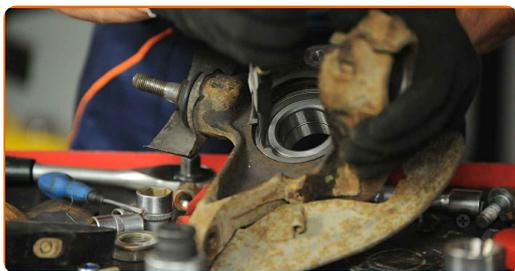
**44** Smontare l'anello interno del cuscinetto che rimane sul mozzo. Usare un set di montaggio/smontaggio cuscinetti e boccole. Usare un separatore cuscinetti
