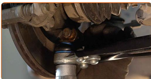
**28** Avvita gli elementi di fissaggio che collegano il giunto sferico al fuso a snodo. Utilizza una chiave a bussola N°16. Utilizza una chiave a bussola N°E8. Usa una chiave a cricchetto.
