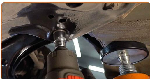
**30** Avvita l'elemento di fissaggio anteriore del braccio. Utilizza una chiave a bussola N°18.
