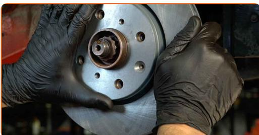
**20** Serrare l'attacco del disco freno. Usa la chiave Torx T30. Usa una chiave dinamometrica. Serralo fino allo coppia di torsione di 5 Nm.
