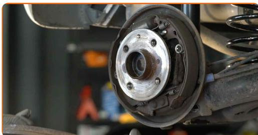
Sostituzione: cuscinetto ruota - PEUGEOT 107 Hatchback (PM, PN). AUTODOC raccomanda:
