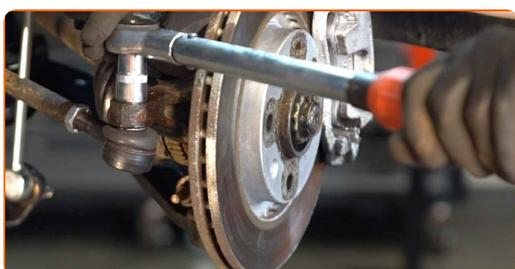
**20** Tratta con del prodotto l'elemento di fissaggio che collega la testina tirante al fuso a snodo. Usa il grasso al rame.
