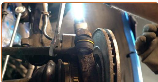
**9** Svitare il dado di attacco del gambo al fuso a snodo. Utilizza una chiave a bussola N°17. Usa un giramaschi.
