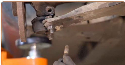
**9** Puntellare il fuso a snodo. Usa un cric idraulico per trasmissione.
