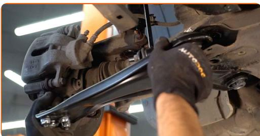
Sostituzione: braccio inferiore anteriore - PEUGEOT 1007 Hatchback.
