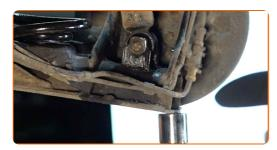
Stringi l'elemento di fissaggio inferiore dell'ammortizzatore. Utilizza una chiave a bussola N°E14. Usa una chiave dinamometrica. Serralo fino allo coppia di torsione di 110 Nm.
