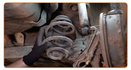
Pulisci le sedi di montaggio della molla elicoidale. Usa una spazzola metallica. Usa lo spray WD-40.
