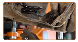
Smonta la parte inferiore dell'ammortizzatore.
