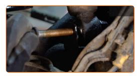
Avvita gli elementi di fissaggio inferiori dell'ammortizzatore. Utilizza una chiave a bussola N°E14.
