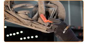
Sostieni la traversa posteriore della sospensione. Usa un cric idraulico per trasmissione.
