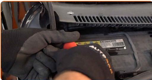
**4** Rimuovi la guarnizione griglia sottoparabrezza.
