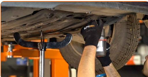
Sostituzione: olio del cambio manuale - OPEL Sintra (APV). AUTODOC raccomanda:
