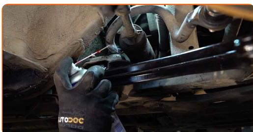
**12** Installa le nuove boccole dello stabilizzatore.
