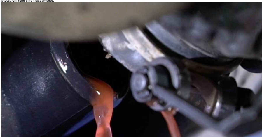
8 Staccare il tubo di raffreddamento.
