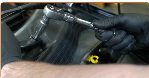
Sostituzione: ammortizzatore a molla - OPEL Corsa D Van (S07). Il consiglio degli esperti di AUTODOC:
