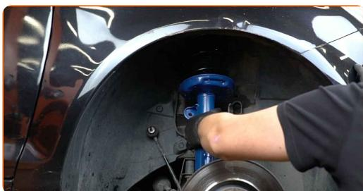
**48** Avvita l'elemento di fissaggio superiore del montante supporto ammortizzazione. Non lo serrare.
