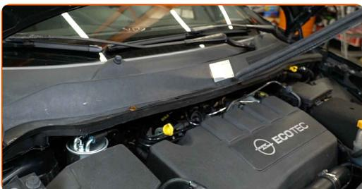
**4** Rimuovi il tappo di protezione del dado del braccio del tergicristallo. Usa uno strumento per estrazione clip.
