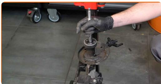
Sostituzione: ammortizzatore a molla - OPEL Corsa D Van (S07). Consiglio:
