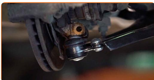
Sostituzione: braccio inferiore anteriore - OPEL Corsa C Van (X01). I professionisti raccomandano:
