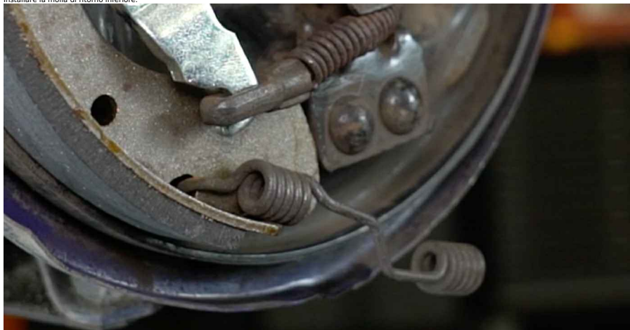
26 Rimuovere la molla superiore ed il regolatore.
