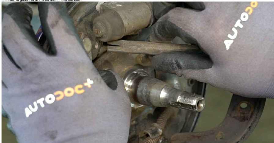
18 Rimuovere la ganaschia del freno destra.
