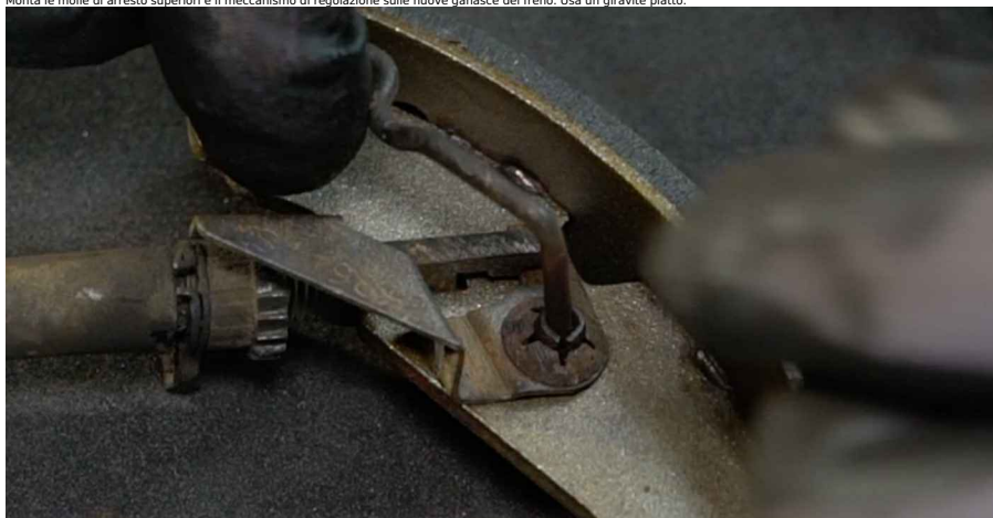
club-auto-doc.it 11-18 36 Installare una nuova ganaschia del freno destra.
