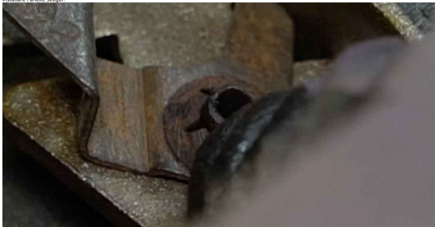
35 Monta le molle di arresto superiori e il meccanismo di regolazione sulle nuove ganasche del freno. Usa un giravite piatto.
