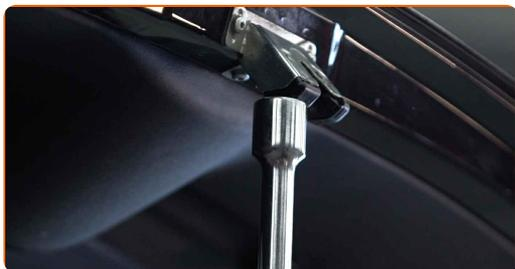
**3** Sgancia l'anello elastico che collega il puntello di supporto a gas al cofano. Usa un giravite piatto.
