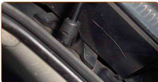
**10** Rimuovi il cric per trasmissione idraulica.
