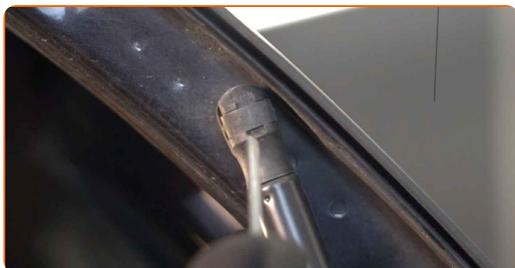
**4** Sgancia l'anello elastico che collega il puntello di supporto a gas alla carrozzeria dell'auto. Usa un giravite piatto.
