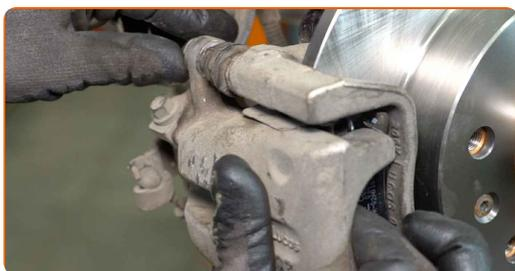
**19** Stringere l'elemento di fissaggio del tubo del freno. Utilizza una chiave a bussola N°E11. Usa una chiave dinamometrica. Serralo fino allo coppia di torsione di 15 Nm.
