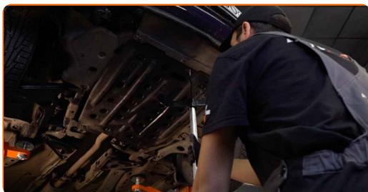
5 Allenta gli elementi di fissaggio del coperchio inferiore della coppa dell'olio. Utilizza una chiave a bussola N°12.
