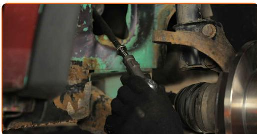
Sostituzione: testine sterzo - OPEL Corsa A CC (S83). I professionisti raccomandano:
