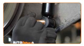
Avvita gli elementi di fissaggio inferiori dell'ammortizzatore. Utilizza una chiave a bussola N°E20. Usa una chiave a cricchetto.
