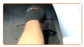
Avvita gli elementi di fissaggio superiori dell'ammortizzatore. Utilizza una chiave a bussola N°E18. Usa una chiave a cricchetto.
