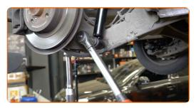
Serrare il perno di fissaggio superiore dell'ammortizzatore. Utilizza una chiave a bussola N°E18. Usa una chiave dinamometrica. Serralo fino allo coppia di torsione di 90 Nm.
