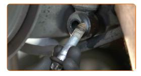
Svita l'elemento di fissaggio superiore dell'ammortizzatore. Utilizza una chiave a bussola N°E18. Usa un giramaschi.
