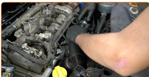
**7** Copri il tubo di aspirazione con un panno in microfibra per evitare che la polvere e lo sporco possano penetrare all'interno del sistema.
