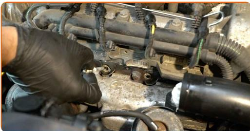
**13** Stringere le candele. Usa la chiave a bussola per candele numero 8. Usa una chiave dinamometrica. Serralo fino allo coppia di torsione di 10 Nm.
