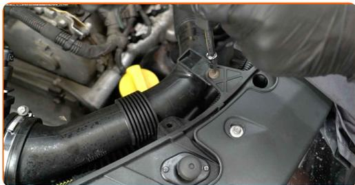
**5** Scollega il collare di fissaggio del tubo di aspirazione. Utilizza una chiave a bussola N°7. Usa una chiave a cricchetto.
