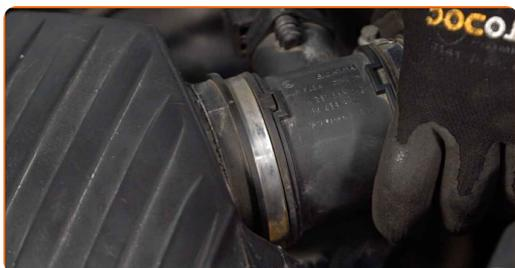
**15** Fissa il collare di fissaggio al tubo di aspirazione. Utilizza una chiave a bussola N°7. Usa una chiave a cricchetto.
