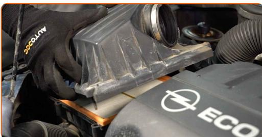
**7** Rimuovere dall'alloggiamento del filtro l'elemento filtrante da sostituire.
