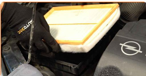
**8** Copri il tubo di aspirazione con un panno in microfibra per evitare che la polvere e lo sporco possano penetrare all'interno del sistema.
