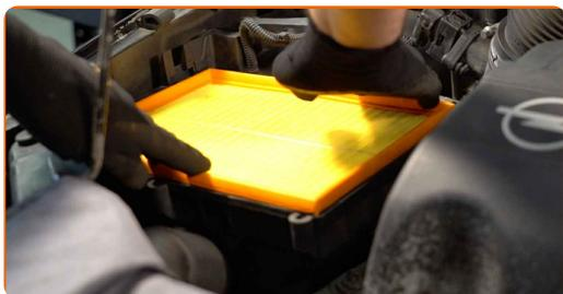
Sostituzione: filtro aria - OPEL COMBO Tour. Gli esperti di AUTODOC raccomandano:
