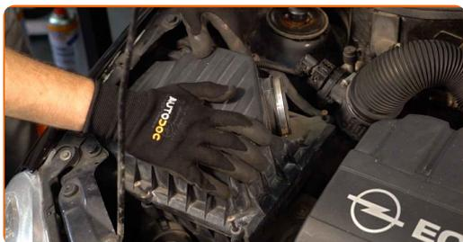
**13** Avvita le viti di serraggio sul coperchio del filtro dell'aria. Usa un cacciavite Phillips.
