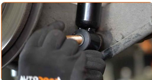
**18** Avvita gli elementi di fissaggio inferiori dell'ammortizzatore. Utilizza una chiave a bussola N°E20. Usa una chiave a cricchetto.
