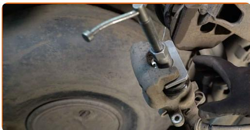
**31** Montare la pinza del freno e fissarla.
