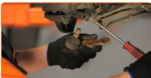
**14** Rimuovi i bulloni di fissaggio (2 pezzi). Usa un giravite piatto.
