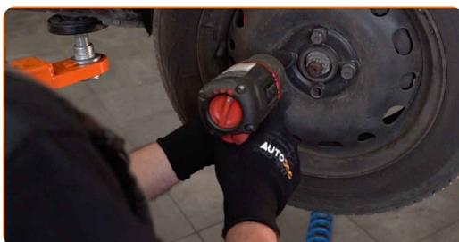
Sostituzione: testina braccio oscillante - OPEL COMBO (71\_). Consiglio:
