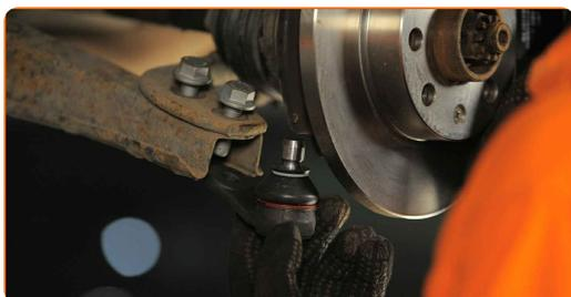
Sostituzione: testina braccio oscillante - OPEL COMBO (71\_). Gli esperti di AUTODOC raccomandano:
