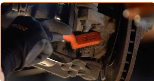
**7** Svitare il perno che fissa il giunto sferico al fuso a snodo. Utilizza una chiave combinata N°13. Utilizza una chiave a bussola N°13. Usa una chiave a cricchetto.
