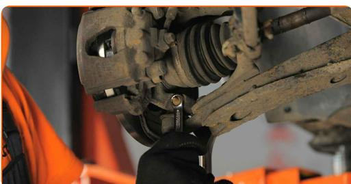
**8** Rimuovi i bulloni di fissaggio. Usa un martello.
