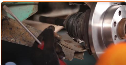
**15** Pulisci la sede di montaggio del giunto sferico. Usa una spazzola metallica. Usa lo spray WD-40.
