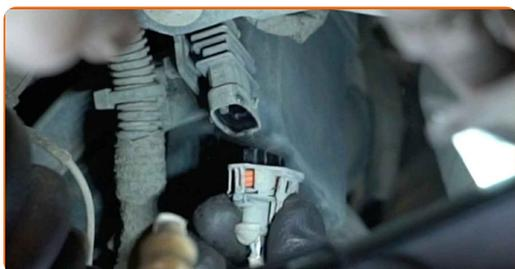
**6** Svitare l'elemento di fissaggio del sensore di ossigeno. Utilizzare una chiave poligonale aperta#22.
