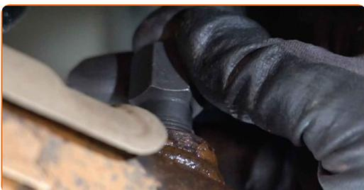
**9** Applicare un prodotto trattante sul sensore di ossigeno. Utilizzare grasso ceramico per alte temperature.
