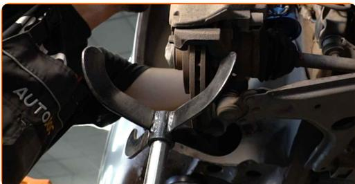
**48** Installa il fermo di arresto del supporto superiore del puntone dell'ammortizzatore. Usa le pinze per pompa ad acqua.
