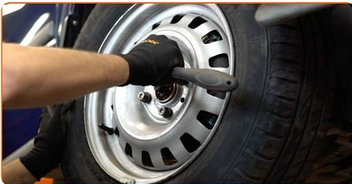
32 Rimettere il veicolo per terra e, lavorando in ordine incrociato, serrare i bulloni di fissaggio delle ruote. Usa una chiave dinamometrica. Serralo fino allo coppia di torsione di 110 Nm.
